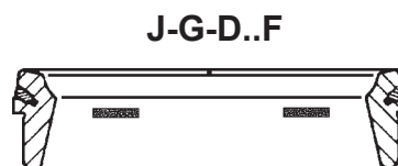
J-G-D..F komb. Docht-/Filzschmierung mit Abdeckung comb. wick/felt lubrication with cover
